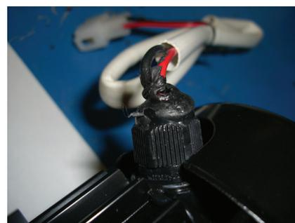
Fig. 3: Deformazione del mastice sigillante su una pompa di circolazione non originale
